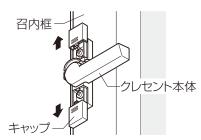
②プラスドライバーでクレセントを固定しているねじを取外します。
