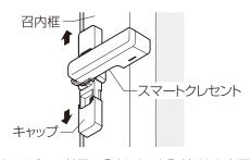
②プラスドライバーで付属の②クレセント取付けねじを固定します。 ※ねじを固定した後、キャップを閉めてください。
