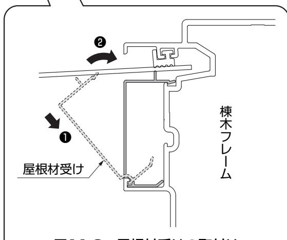
図11-2 屋根材受けの取付け
