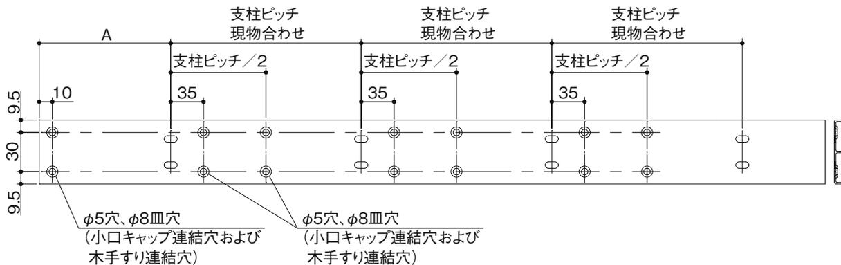
④手すり受けの上り始まり側を木手すりの3mm内側に合わせた後、上り終わり側を木手すりの3mm内側となる位置に墨出しし切断してください。その後、小口キャップおよび木手すり連結用の皿穴を加工してください。
