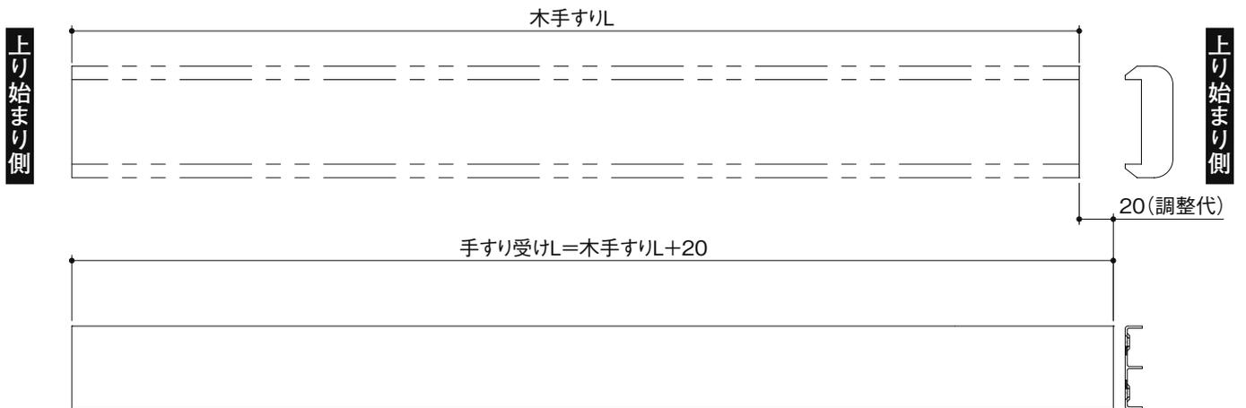
②A寸法を算出してください。その後、支柱ピッチを現物合わせで墨出ししてください。
