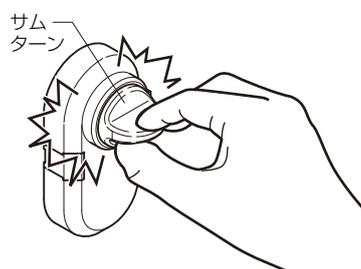
※特に登録スイッチを押した後の、電動サムターンが一度動くときは注意してください。触ってしまいその後、サムターンが固くなる場合は登録スイッチをもう一度押して電動サムターンを動かしてください。
