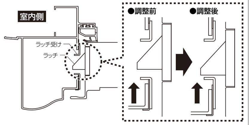
② デッドボルトがストライクに当たらないようにストライクを調整します。
