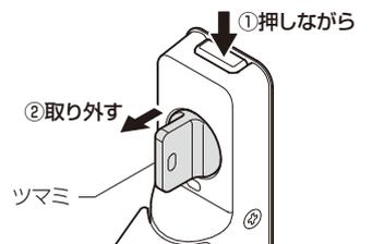
サムターンのツマミを取り外せますので、外出時に外しておけば、ガラス破りなどによる不正な操作を防げます。
