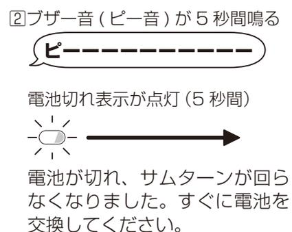
※電池切れ表示が点滅①してから電池切れ②になるまで数十回操作できますが表示が点きましたら速やかに電池を交換してください。
