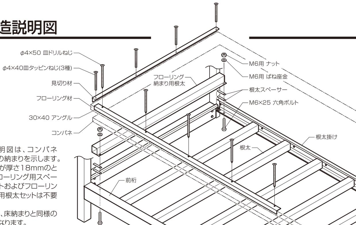
※構造説明図は、コンパネ12mmの納まりを示します。コンパネが厚さ18mmのときは、フローリング用スペーサーセットおよびフローリング納まり用根太セットは不要です。
