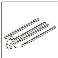
①前枠にシーリングし、前枠コーナーキャップを取付けてください。
