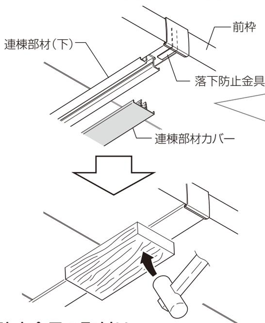
前枠側の連棟部材カバー溝部を先に落下防止金具に差し込んでください。
