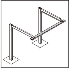
①前枠を前枠施工補助金具に引っ掛け【8-1】で仮固定してください。
