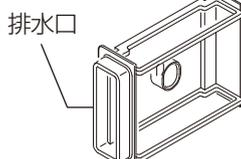
排水の向きに合わせて、排水部品Aの向きを変えることができます。
