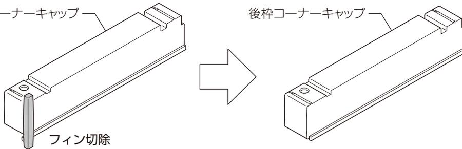
②連結部の後枠コーナーキャップを取付けてシーリングしてください。
