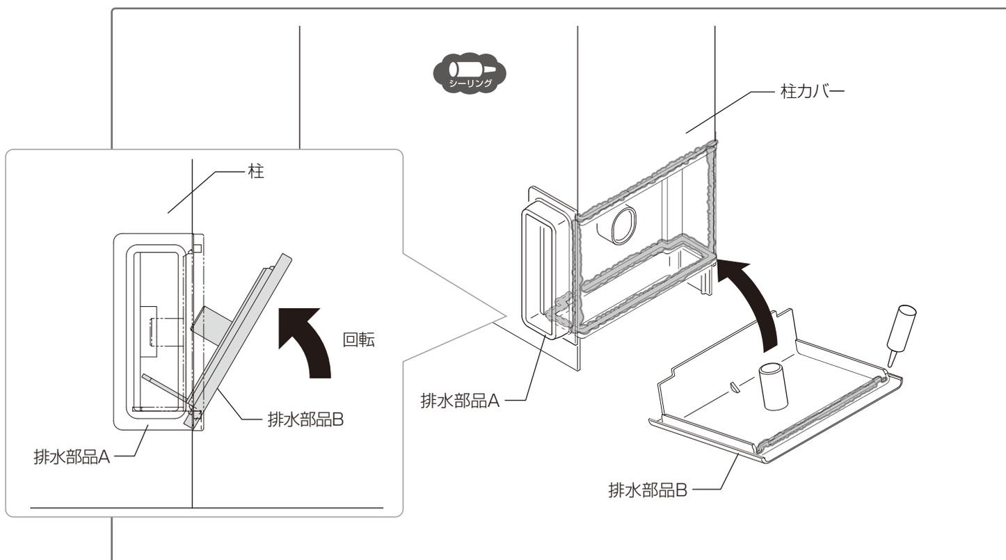
⑦排水部品Aにシーリングをして、排水部品C-1を【8-6】で取付けてください。
