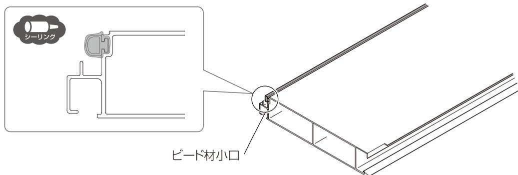
②先に取付けた屋根材の切欠き部に30mmシーリングしてください。
