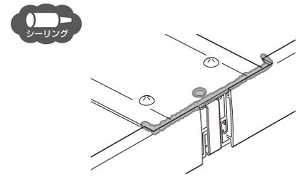
④連結カバーを【11-1】で取付けてシーリングをしてください。
