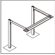
①屋根材(1枚)を前枠に引っ掛け、裏板と【8-1】で仮固定してください。
