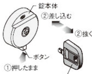
セキュリティサムターンの 取り外し方・取り付け方
