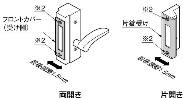
① フロントカバー（受け側）・片錠受けは、上下のネジをゆるめて調整してください。（※2）
