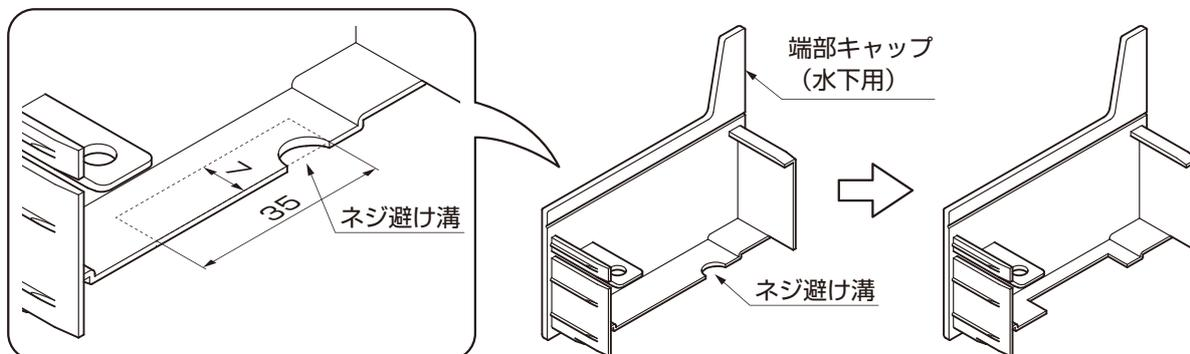
②水下側が化粧樋エルボ仕様(直角)納まりの場合、水下側の端部キャップをネジ避け溝の位置を基準に切り欠いてください。
