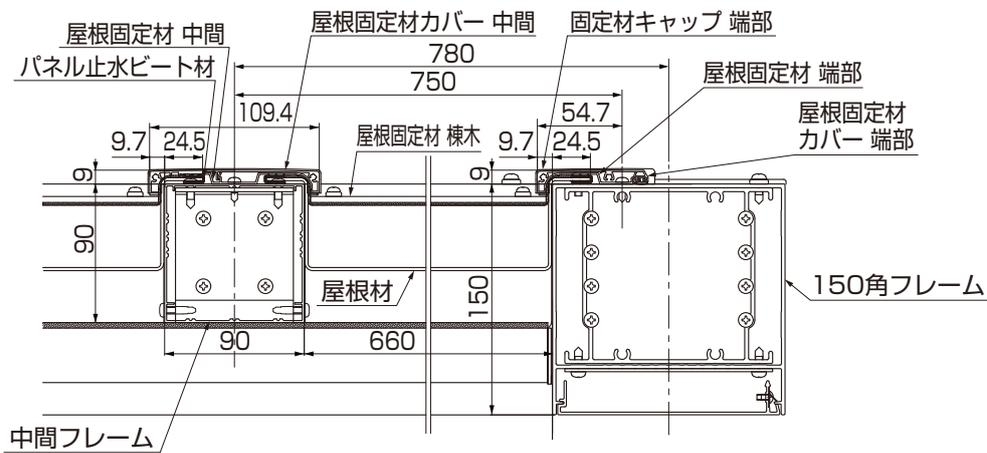
図3-9 C-C'断面詳細図 150角の場合
