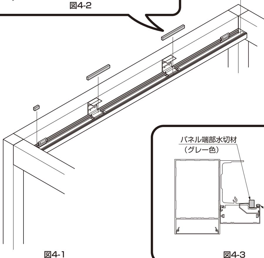
① 樋にパネル端部水切材 端部・中間用を取付けてください。(図4-1、図4-2参照)
