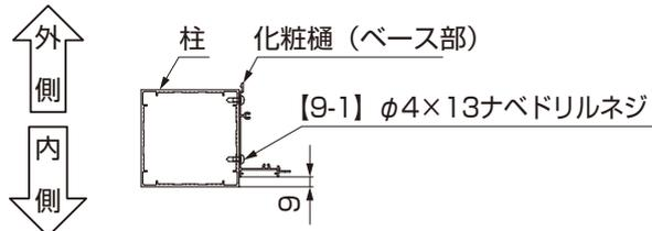
●柱の場合 (150角フレームのGウォールの柱に取付ける場合)
