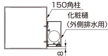
②化粧樋 (意匠部) の排水側に92°エルボ用の穴加工をし、化粧樋 (ベース部) にはめ込み (図11-96参照)、裏面を【9-1】で固定してください。
