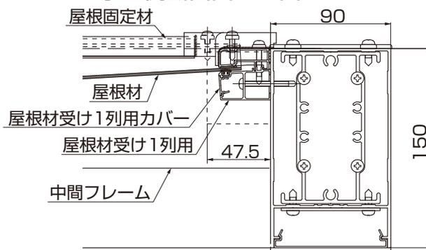
図3-12 E-E'断面詳細図
