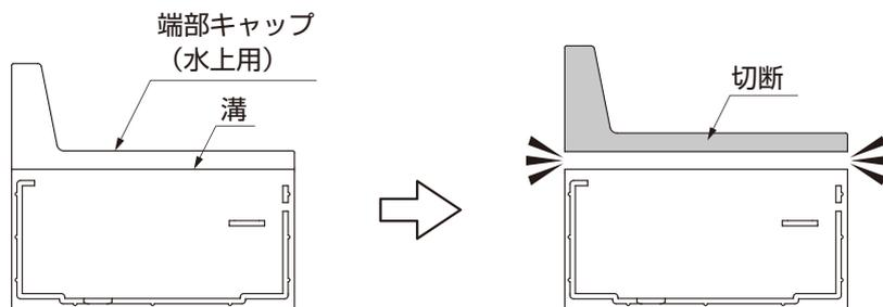
①水上側の端部キャップの上部を部品の溝に沿って切り落としてください。
