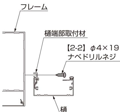
図2-9 B部詳細図端部
