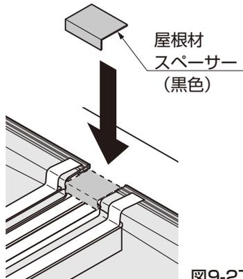
屋根材<br>スペーサー (黒色)<br>図9-27                    | 屋根固定材 棟木の取付け<br>
