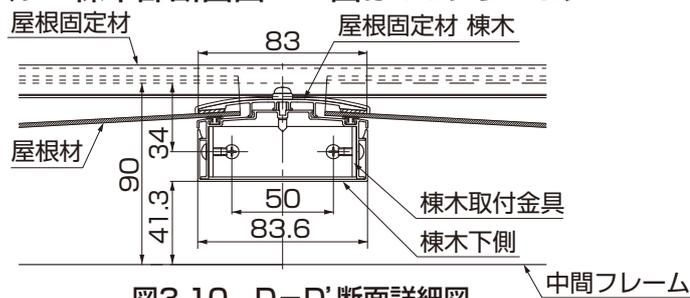
図3-10 D-D'断面詳細図
