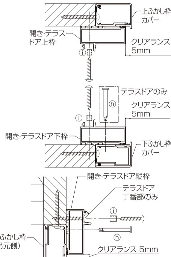
・ふかし枠40に、縦枠（戸先）を当てて、ハンドル受けライナーの位置のふかし枠カバーのリブをのこぎり、又はプラスチックカッターなどでカットします。カットする寸法は56mmです。（ふかし枠40の場合のみ）
