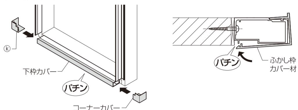
②縦枠カバーの上部にコーナーカバーを差し込み、下枠のコーナーカバーに差し込みかん合します。
