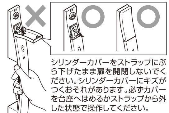
シリンダーカバーをストラップにぶら下げたまま扉を開閉しないでください。シリンダーカバーにキズがつくおそれがあります。必ずカバーを台座へはめるかストラップから外した状態で操作してください。
