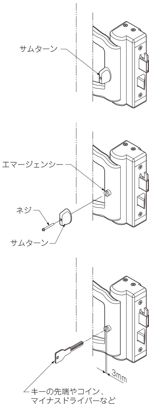
①出荷段階では、家側にはサムターンが付いていますので、手で施錠・解錠の操作が行えます。
