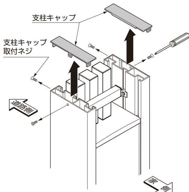
①支柱キャップ取付ネジを外し、支柱キャップを取外します。
