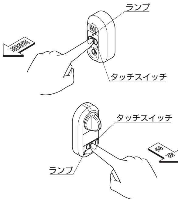
①タッチキーリモコンを携帯してタッチスイッチを押すと、ランプが点灯して解錠・施錠します。
