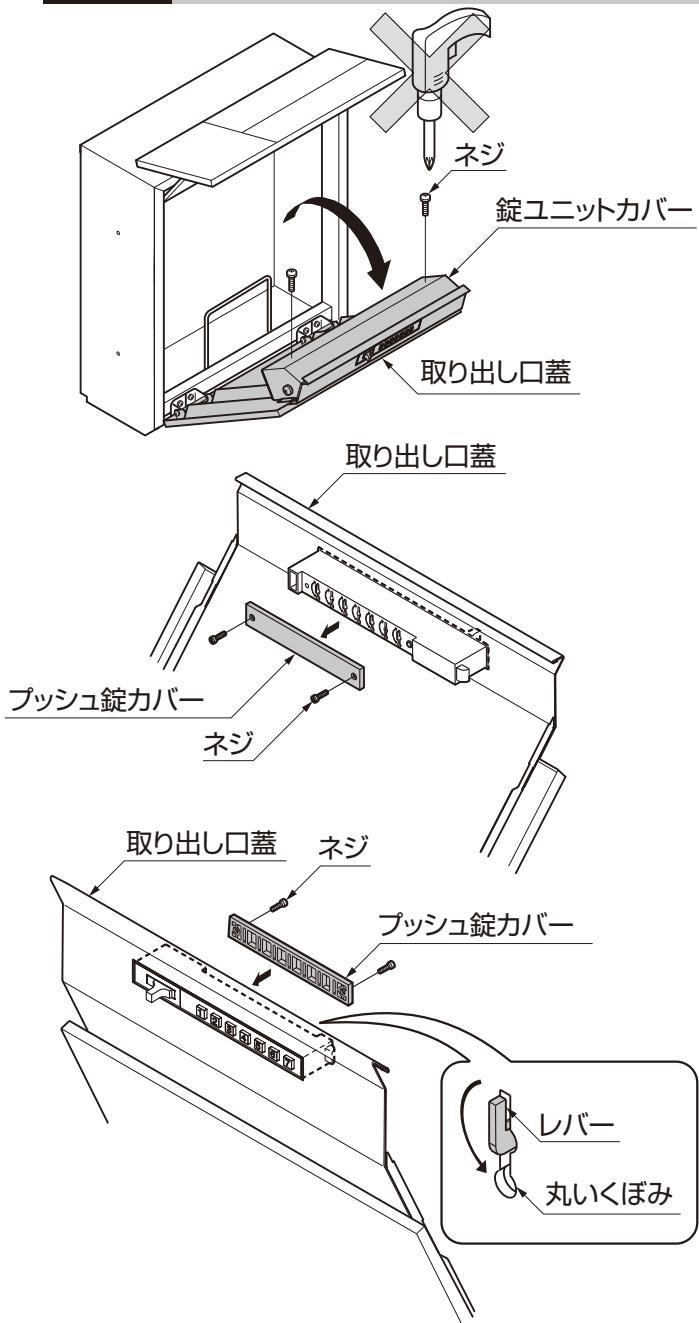
①「3-2 取り出し口蓋の開閉方法」を参照し、取り出し口蓋を開けます。
