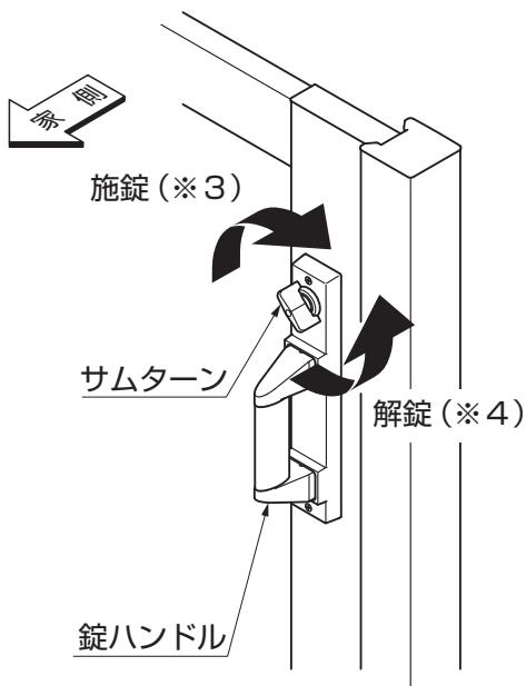
①サムターンで施錠・解錠するには、表4-2を参照して操作します。
