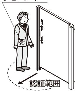
●ノータッチモードでは、リモコンキーを携帯し、門扉に近づくだけでノーアクションで解錠する事ができます。認証範囲の境界付近では意図せず解錠するなどの誤動作が発生しますので下記、注意事項をご理解の上ご使用ください。
