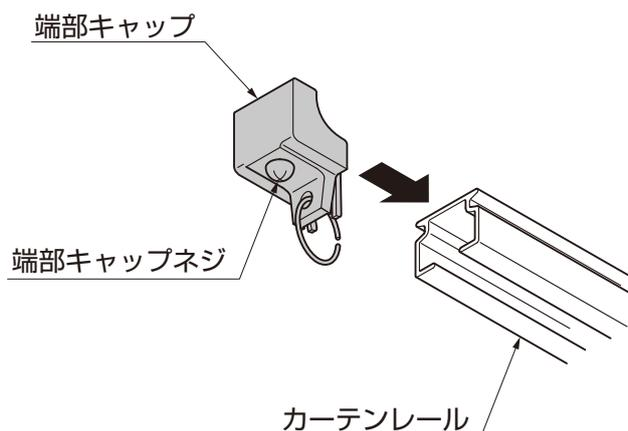
③取外した端部キャップを取付け、ネジを締めます。
