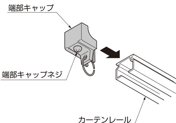
③取外した端部キャップを取付け、ネジを締めます。
