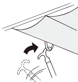
・必ず日除け開閉棒を使って開閉してください。部品が摩耗・損傷し開閉しにくくなるおそれがあります。
