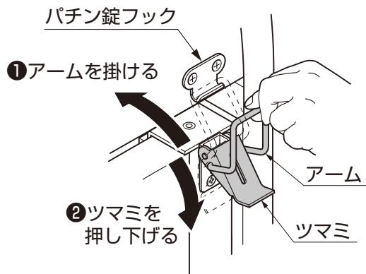
④パチン錠のアームをパチン錠フックに掛け、ツマミを下に押し下げるとパチン錠が掛かります。
