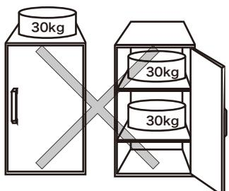
●棚上・棚板に30kgを超える重いものをのせたり、吊るしたりしないでください。部材が変形・破損しケガをするおそれがあります。また、棚上のみに物を置かないでください。転倒し、ケガや破損のおそれがあります。
