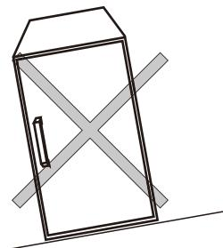
●床面の平らな場所に水平になるように置いてください。転倒によりケガをしたり、商品の変形の原因になります。
