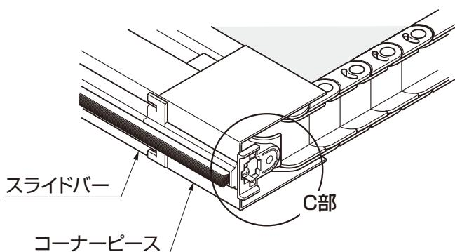
①網戸の開閉の際にスライドバー下部より異音（キー音）が発生する場合があります。その場合は、スライドバー下部のコーナーピース（C部）が汚れていると思われますので、網戸本体を取り外し、ブラシなどで汚れを取除いてください。
