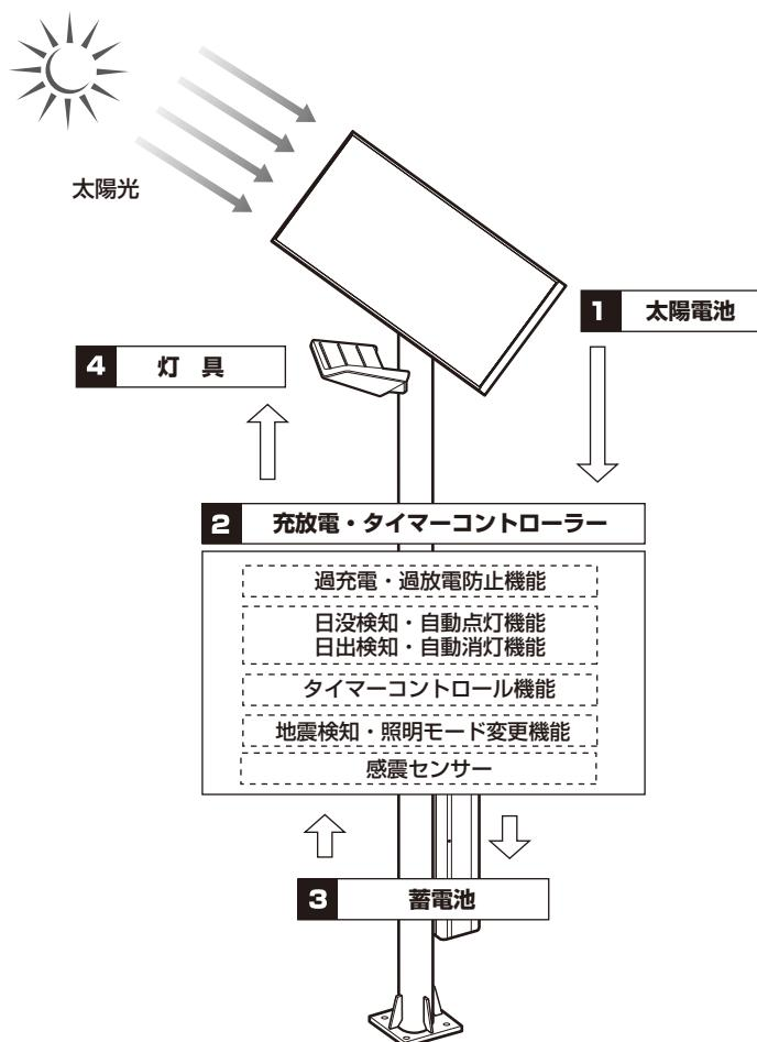
**1 太陽電池** 太陽の光エネルギーを直接電気エネルギーに変換します。また、周囲が暗くなると出力電圧が低下する特性を利用し、灯具を点灯させるセンサーのはたらきもします。
