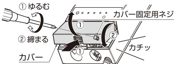
①カバー固定用ネジをゆるめ、カバーの下部を押しながら、回転させるようにして外します。
