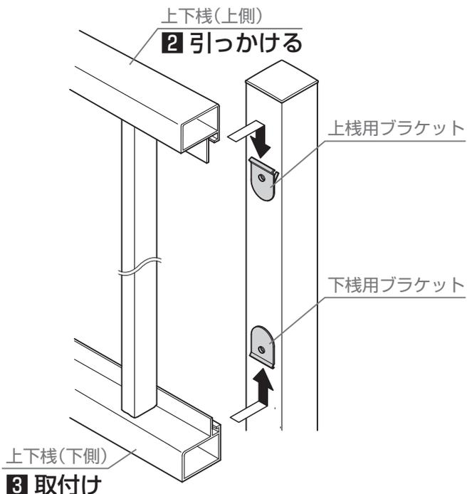
4: 上棧用ブラケットと下棧用ブラケットを【2a】【2b】【2c】でしっかりと締め付けて固定
