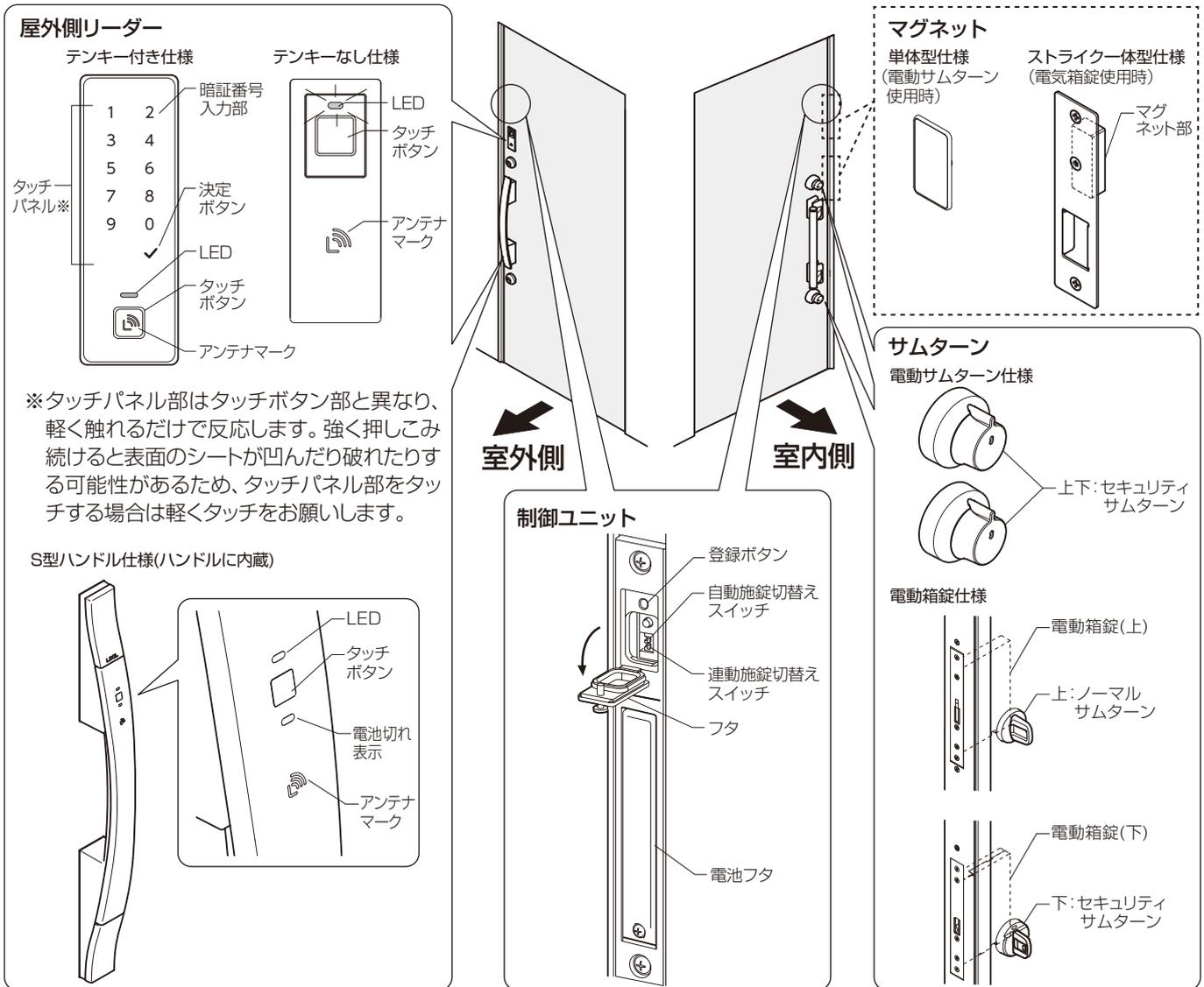
※タッチパネル部はタッチボタン部と異なり、軽く触れるだけで反応します。強く押しこみ続けると表面のシートが凹んだり破れたりする可能性があるため、タッチパネル部をタッチする場合は軽くタッチをお願いします。
