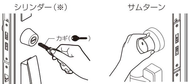
※ S 型ハンドルの場合は、シリンダーカバーを外してからカギ (●) を挿入し手で回して施解錠します。
