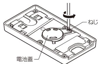
③マイナスドライバーをねじの根元に差し込み電池蓋を外します。
