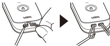
③引き張りだしたひもにストラップの根本側を通し完了です。
