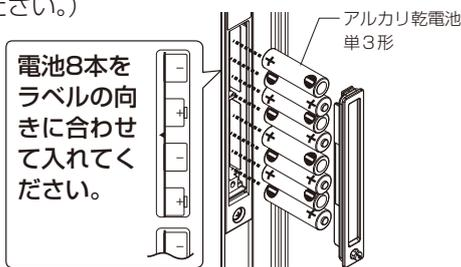
④電池フタを閉め、ねじを締めます。
