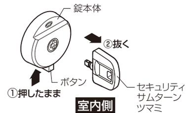
サムターンのツマミを取外せますので、外出時に2個とも外しておけば、ガラス破りなどによる不正な操作を防げます。
