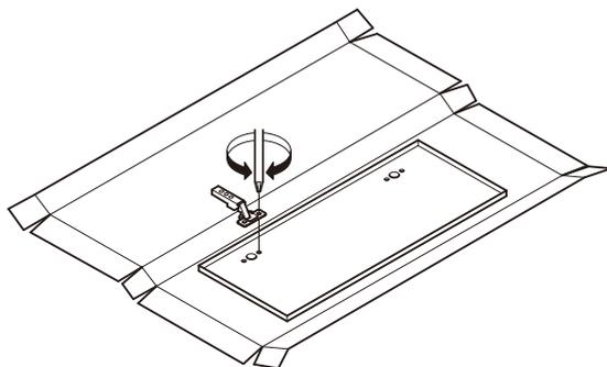
本体損傷を防ぐため、本体の下をダンボールなどで養生してください。
