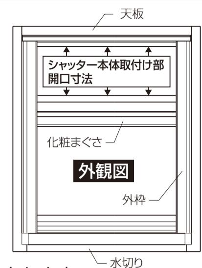
●シャッターボディの施工およびメンテナンスのため、下図のスペースをあけてください。
