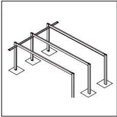
①柱キャップを【10-3】で取付け、シーリングしてください。
