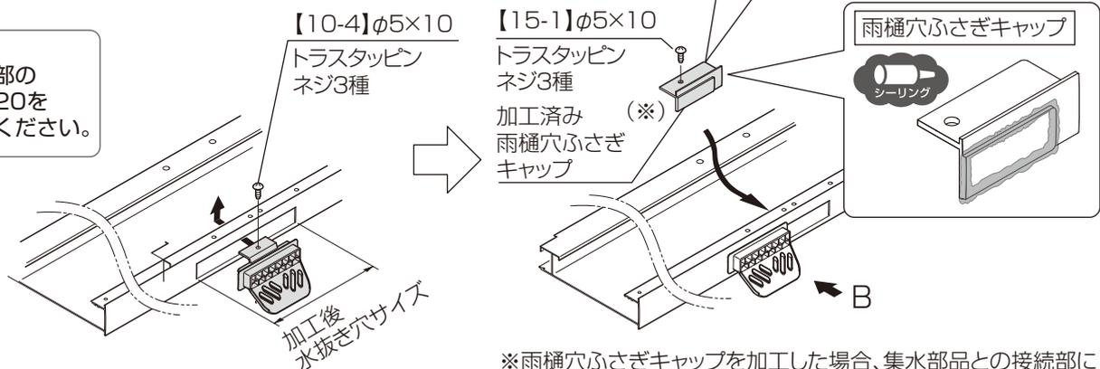
※雨樋穴ふさぎキャップを加工した場合、集水部品との接続部にもシーリングしてください。
