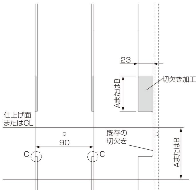
※C部がGLより上になる場合は、既存の切欠きの角が露出しますので、切り落とすか基礎の中に埋める等の処理をしてください。
