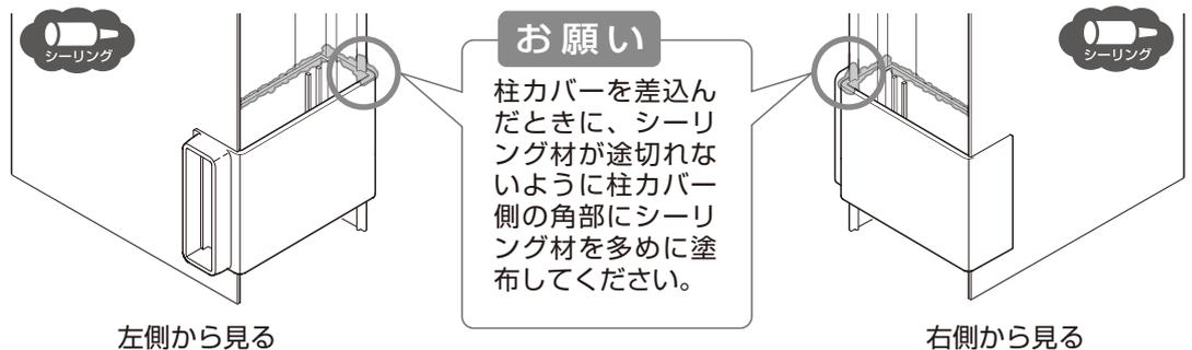
⑥柱カバーを後枠と柱の隙間に差し込み、柱にはめ込んでください。
