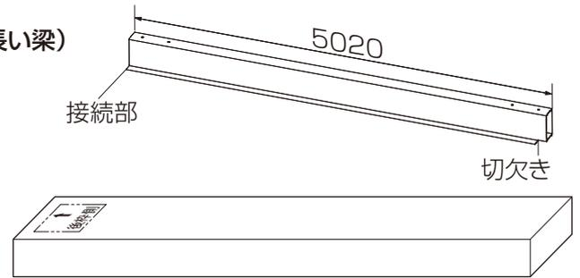
①水下側の梁の接続部に穴加工をしてください。
