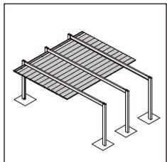
①屋根材同士を引っ掛け裏板と【10-1】で屋根材4枚目までを仮固定してください。
