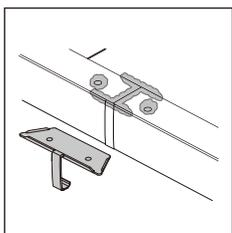
①側枠接続部に止水テープを貼り付けてください。
