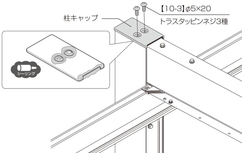
※柱キャップは前枠側、後枠側の両方に取り付けてください。
