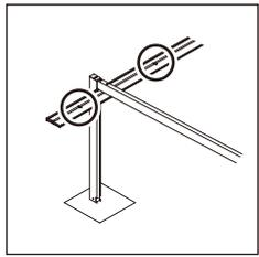
①後枠固定金具を【51】(P.22)でつけた枠の墨出し位置に【11-1】で取り付けてください。
