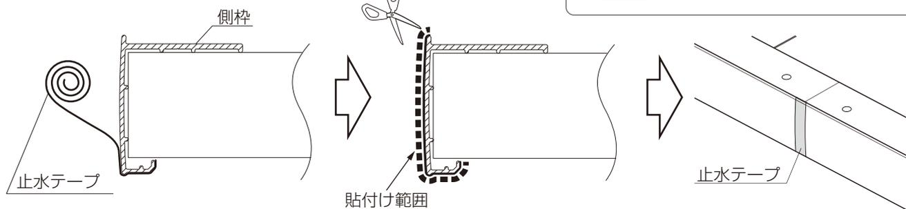
②側枠接続部の上面にシーリングしてください。
