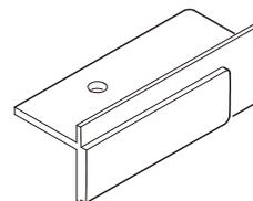
柱移動により雨樋穴ふさぎキャップの取付け穴が無くなる場合があります。移動距離によっては穴を新たにあげ直してください。
