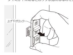
⑤①~③の逆の手順で上げ下げロックを取付け直します。 ⑥半開ロック状態にできることを確認してください。 ②ツマミを上下にスライドし上下の取付けねじを外します。
