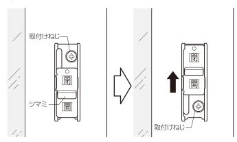
④裏板取付けねじを半回転ゆるめ、ガラス面側へ裏板を寄せてください。寄せたらねじを締めてください。
