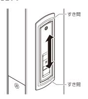
③調整した戸先錠がずれないように固定し、戸先錠取付けねじを締めてください。 ※取付けねじはしっかり締めてください。
