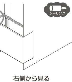
⑥柱カバーを後枠と柱の隙間に差し込み、柱にはめ込んでください。
