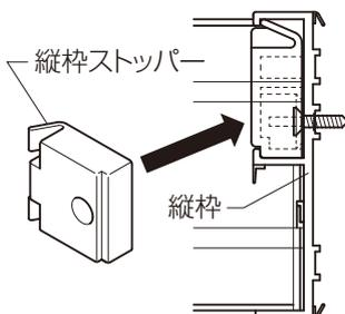
縦枠ストッパーがある機種は縦枠ストッパーを外してから化粧カバーを取付けてください。
