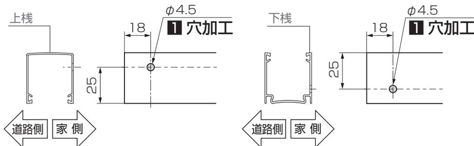
2: 上枠、下枠にφ4.5の穴加工
