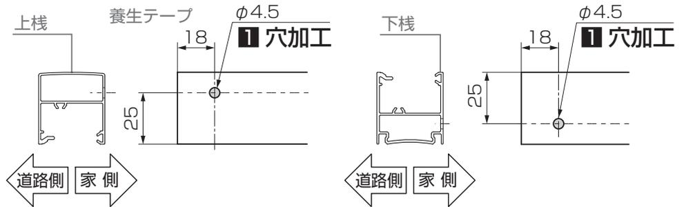
2: 上枠、下枠にφ4.5の穴加工
