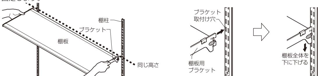
※必ず2本の棚板用ブラケットが同じ高さになるように設置してください。
