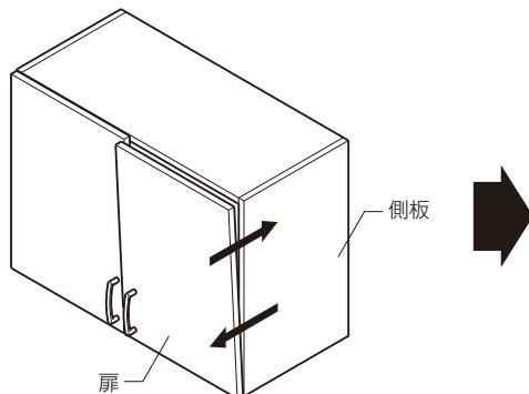
※調整後、調整ねじを必ず締直してください。
