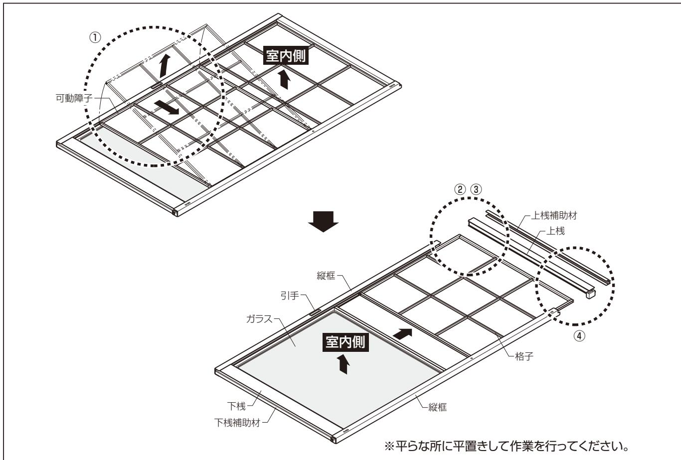
①可動障子を格子面から見て右側に押込み、持上げて外します。
