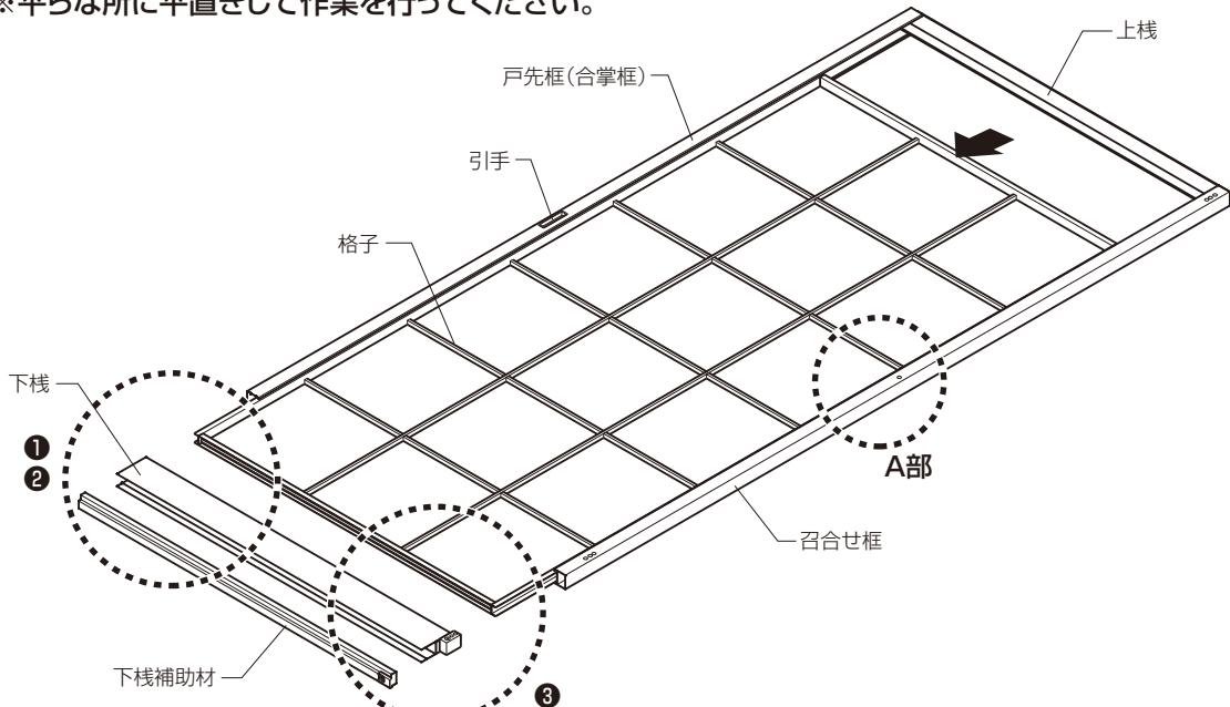
①下桟の底の調整ねじを左に回してゆるめ、下桿補助材キャップと下桿補助材を外します。
