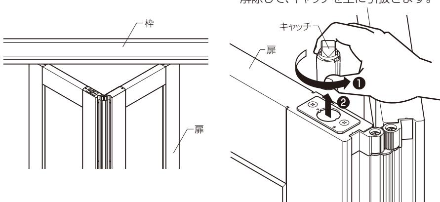
③キャッチ下面の調整ねじをプラスドライバーで回して調整してください。
