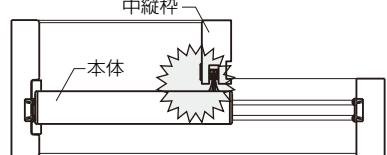
本体と中縦枠モヘアが接触しすぎると、開閉が重くなります。
