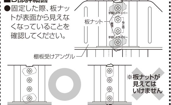
※ドライバーにて固定後、棚板受けアングルに下方向の荷重をかけ、しっかりと固定されていることを確認してください。
