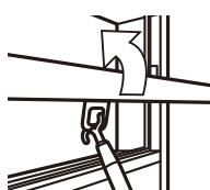
閉：金具のくぼみにフック棒をあて押し上げるよにして閉じます。
