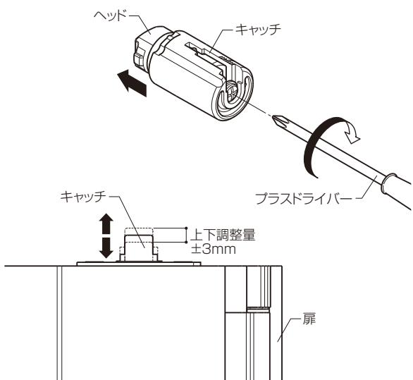
④キャッチを取り付け穴に差込み、キャッチのヘッドを右に回してロックしてください。
