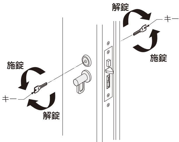
①キーで施錠・解錠するには、図にしたがって操作します。
