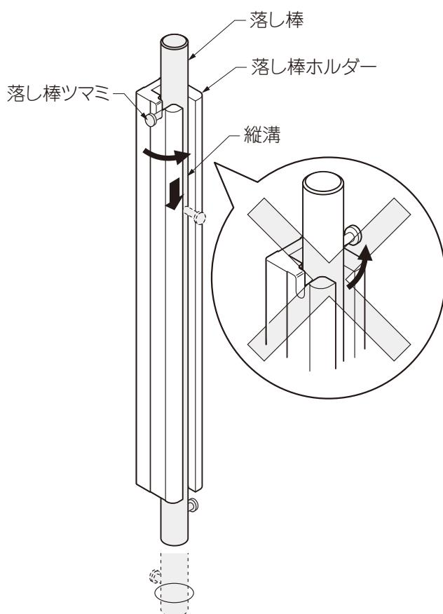
①落し棒ツマミを縦溝の位置まで回転し、縦溝に沿って落し棒を下げます。
