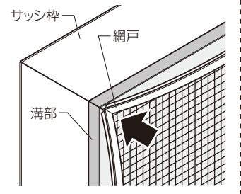
※はめ込む前に網戸コーナー部のアタッチメントにすき間がある場合は、①長い方のアタッチメントを先に金具の根元まで押し込み、続いて②短い方のアタッチメントを金具に押し込んでから網戸を取り付けてください。
