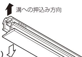
取付け済みの網戸アタッチメントの内側に配置して、端部から溝に取付けしていきます。
