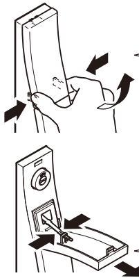
シリンダーカバーの下部（グリップに近い部分）を軽くつまんで引っ張ると外れます。シリンダーカバーを取付ける場合は、上部（グリップに遠い部分）のツメを先に挿入してください。無理にはめ込むとツメが破損するおそれがあります。
