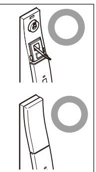
シリンダーカバーをストラップにぶら下げたまま扉を開閉しないでください。シリンダーカバーにキズがつくおそれがあります。必ずカバーを台座へはめるかストラップから外した状態で操作してください。
