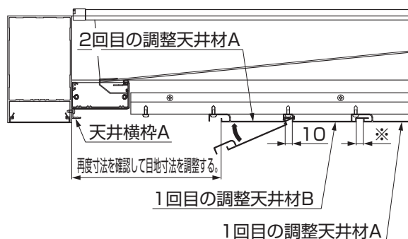
図4-40 2回目の調整天井材Aの取付け
