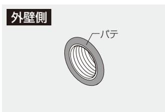
③躯体内配線部品同梱のシーラーは本体から出ている電源線に巻きつけて、本体施工時にPF管の中に押し込んでください。
