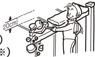
※積雪量は1cmあたり30N/m<sup>2</sup>（比重0.3）にて 算出しています。 ※柱に貼付けてある雪下ろしシールをご確認ください。
