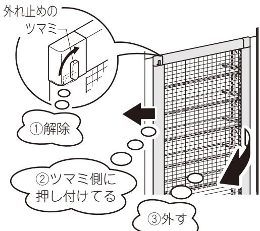
お願い 網戸を取付ける際は落下防止のため、上下の外れ止めを必ずセットしてください。
