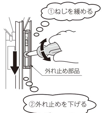
網戸框とサッシ枠との間にすき間が生じる場合に戸車を調整してください。
