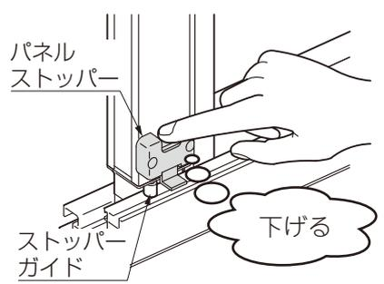
※落とし棒ツマミは折戸パネルを180度の状態にして操作してください。
