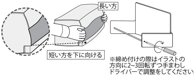
※締め付けの際はイラストの方向に2~3回転ずつ手まわしドライバーで調整してください。
