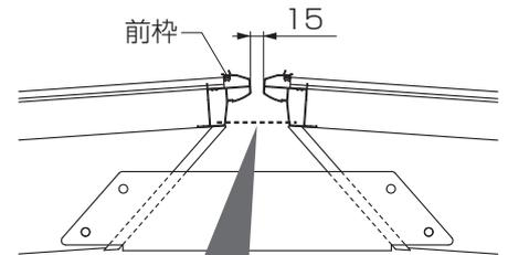
左右の梁の高さを合わせてください。高さに差がでますと合掌棟木が傾いて取り付けられ、漏水するおそれがあります。
