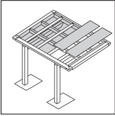
①屋根材を前枠のカバー部に差込み、後枠の屋根材受けに差込んでください。
