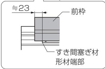
すき間塞ぎ材取付金具取付けピッチ
