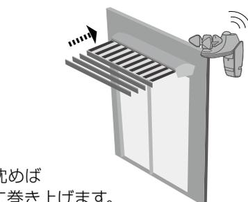
太陽が沈めば自動的に巻き上げます。
