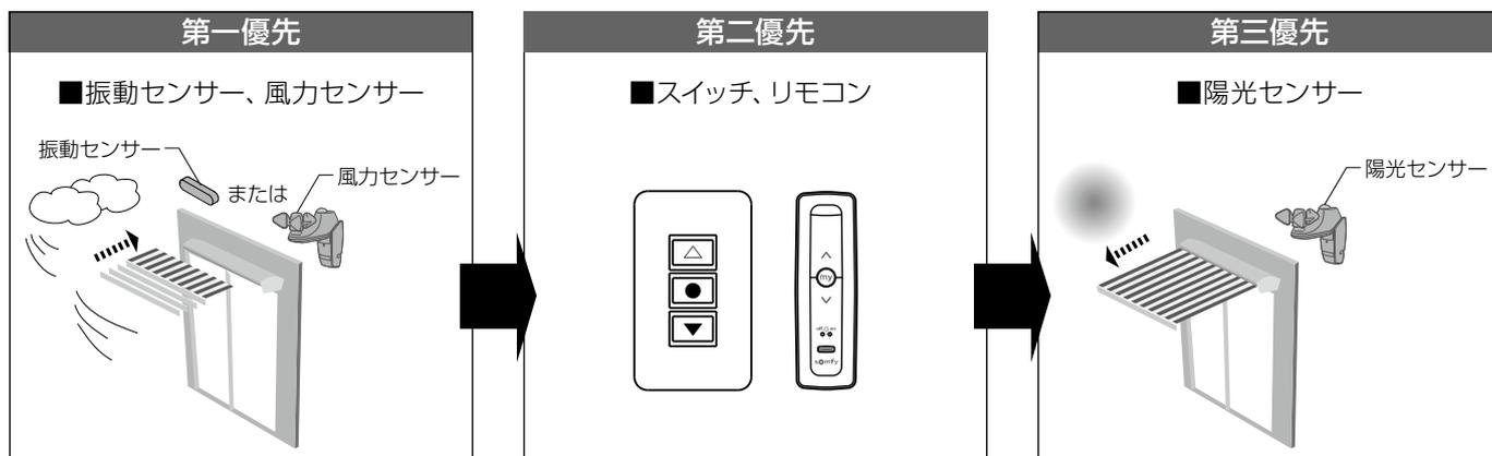
例) リモコン操作 (第二優先) でキャンバスを張出しているときに強風が吹くと、風力センサー (第一優先) が反応し巻き上げられます。
