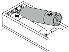
振動センサーの電池が切れると自動的に彩風が閉じます。
