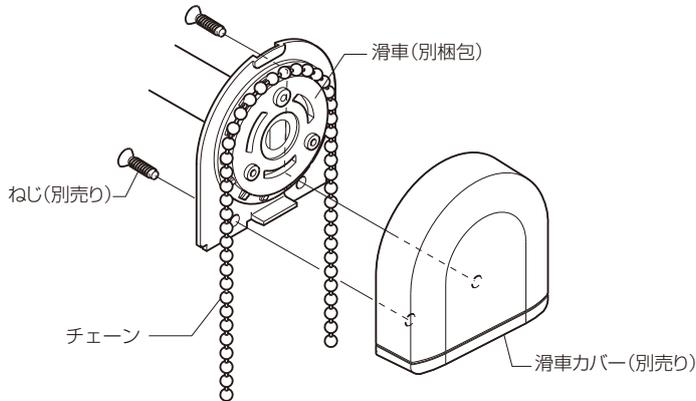
②チェーンカバーを取付ける際は、コードクリップを外してチェーンの下側にチェーンカバーを取付けてください。
