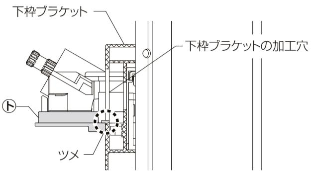
①オペレーターアクションカバーのツメを下枠ブラケットの加工穴の下側にひっかけます。
