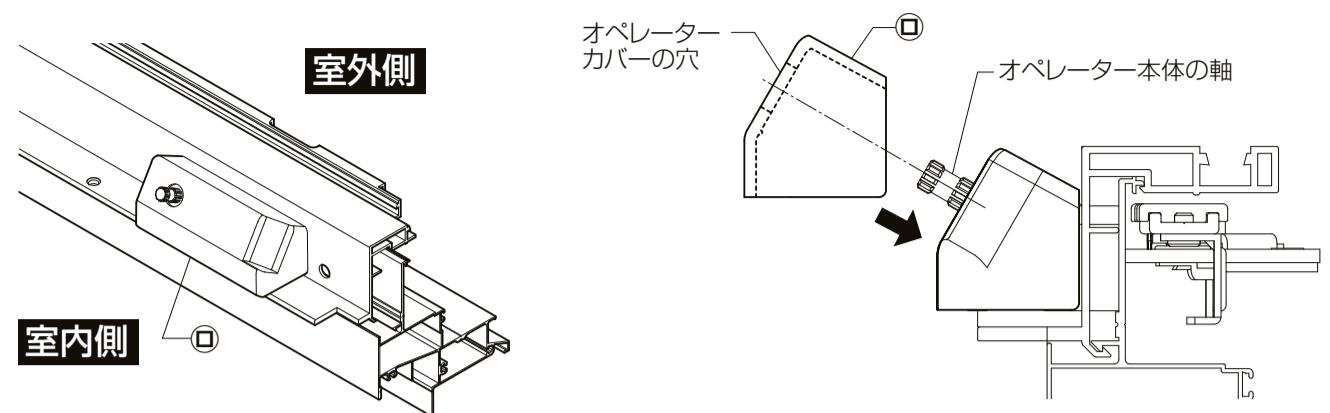
オペレーター本体の軸と、カバーの穴のセンターを合わせて図のようにまっすぐ挿入してください。
