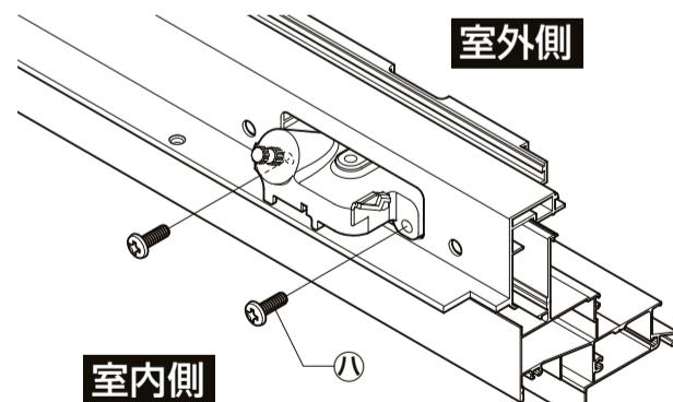
③オペレーターの軸を指で回してアームを室外側に出し、連結板と穴位置を合わせ、アームと連結板をⒺ薄バインド小ねじM4×6で固定します。
