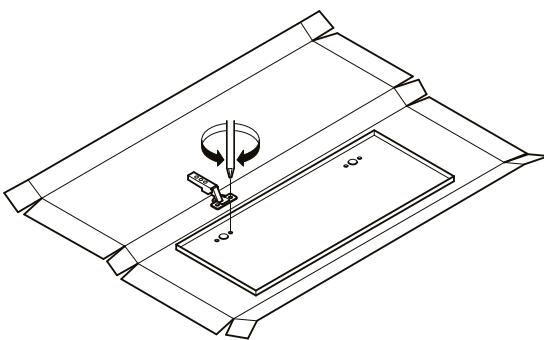
本体損傷を防ぐため、本体の下をダンボールなどで養生してください。
