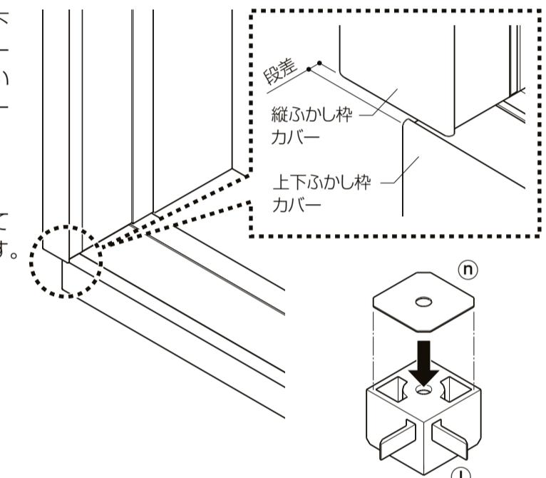
②右図のようにコーナーピースの位置決めリブをふかし枠補強材の中に入れて位置を合わせた後、ねじで固定します。
