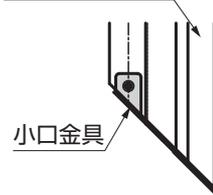
●面枠ベース(右側)の下端に小口金具を右端部に合わせて、φ4×13ナベドリルネジ3種で共締めして取付けてください。
