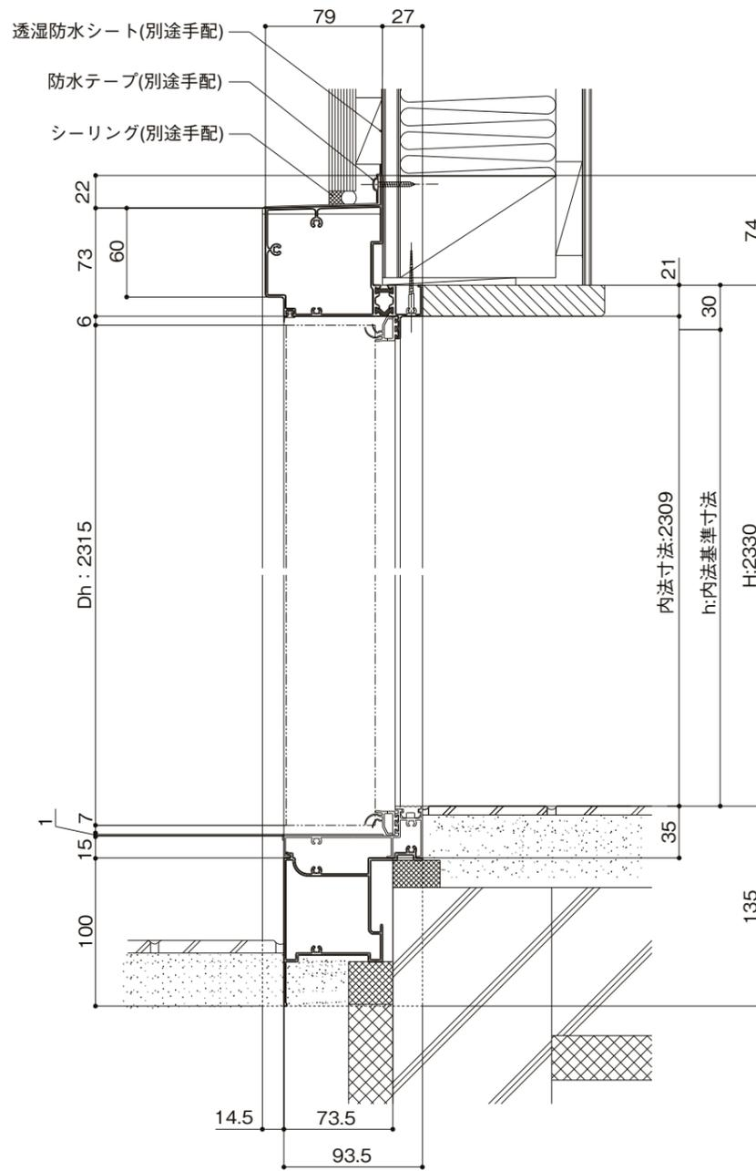
■横断面図(親子断熱枠仕様例)
