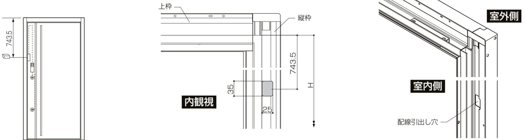
【配線引出し部の木枠切欠き加工例】
