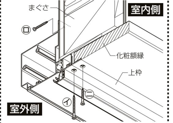
※躯体に固定する際に枠が下記の寸法になっているかを確認して取付けてください。
